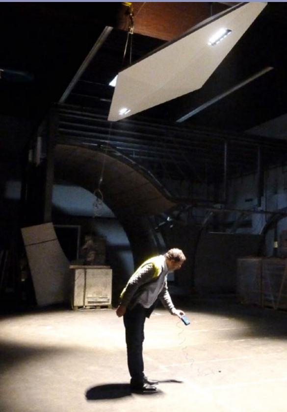
Hochfrequente Dichtheitsmessungen beim Musterbau
