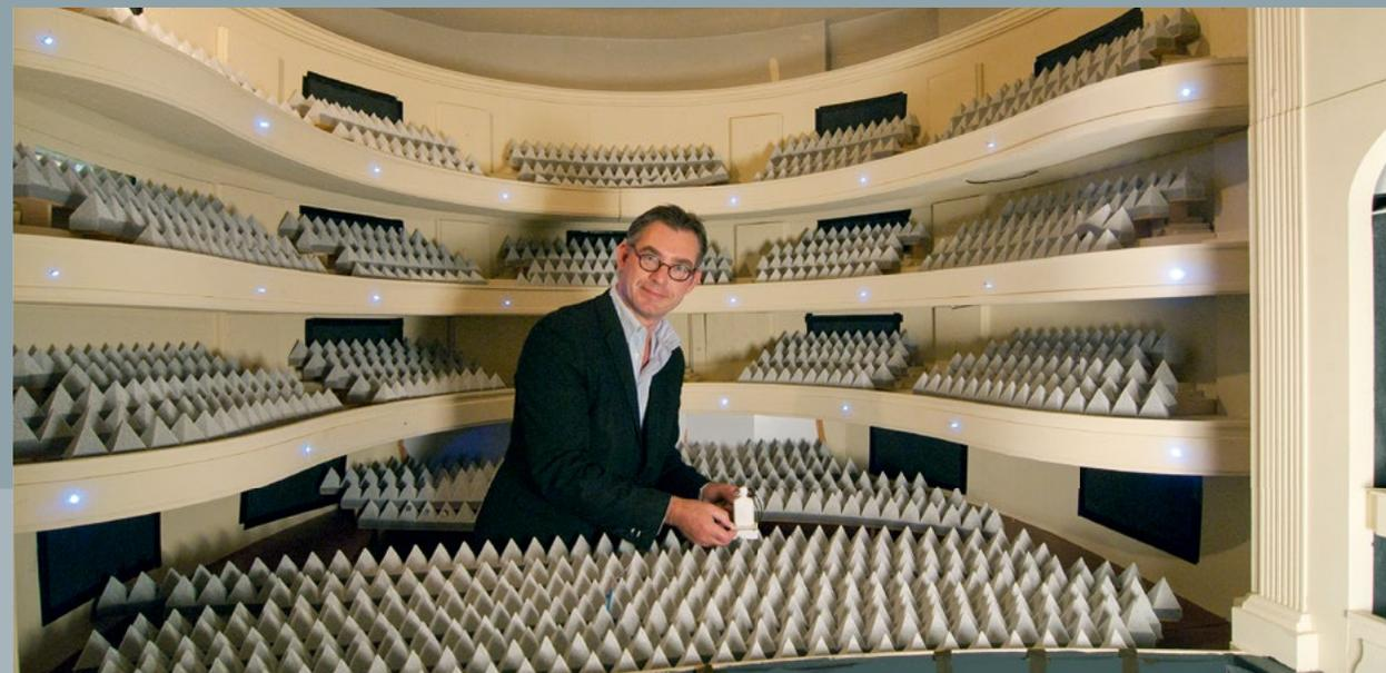
Der Einsatz spezieller Lautsprecher verbunden mit einer besonderen Mikrofontechnik ermöglicht es jedoch, dass auch bei diesen hohen Frequenzen aussagekräftige Messergebnisse erzielt werden können. Anhand der Messergebnisse wurde aufgezeigt, dass das Projektziel durch die Anhebung der Decke erreicht werden konnte.
